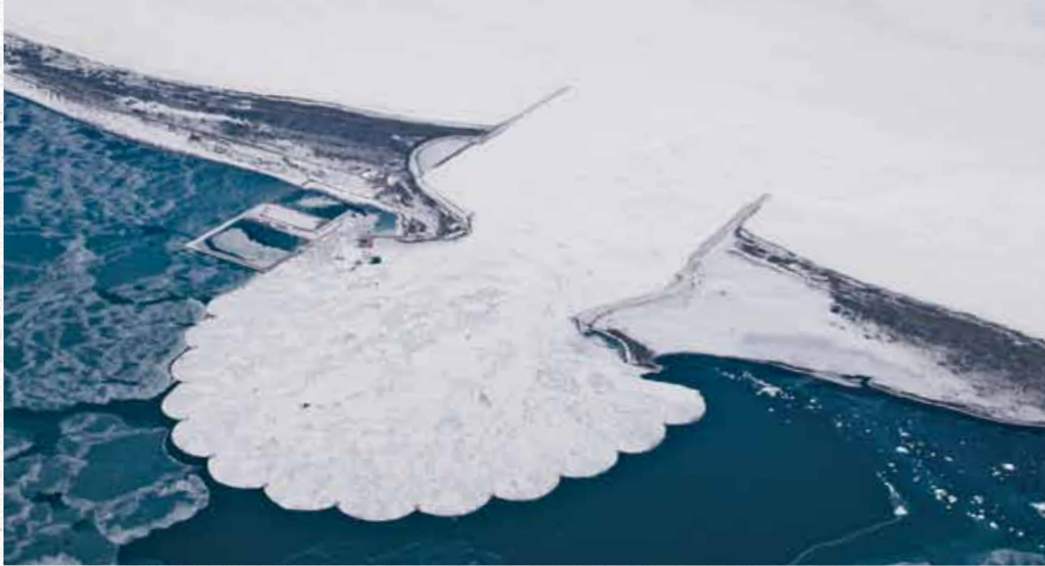
海水(流水)を堰き止めるものとしては世界初の例となったサロマ湖のアイスブーム。(写真提供：網走開発建設部)
